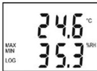
**Bei eingeschaltetem Display** werden die aktuellen Messwerte von beiden Fühlern angezeigt. Das Symbol LOG zeigt an, dass die Aufzeichnung läuft – bei blinkendem Symbol LOG wird angezeigt, dass der Speicher zu mehr als 90% gefüllt ist. Die MIN / MAX Werte zeigen die aufgezeichneten Extremwerte an.
