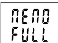
Bei vollem Datenspeicher im Start/Stop-Modus wird die Aufzeichnung gestoppt und im Display erscheint die Meldung MEMO FULL. Diese Meldung erscheint auch bei ausgeschaltetem Display (Stromspar-Modus).
