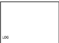
**Bei ausgeschaltetem Display** wird nur LOG angezeigt. Der Logger befindet sich im Energiesparmodus. Es werden nur noch Messungen im Messintervall durchgeführt und der Stromverbrauch ist minimal
