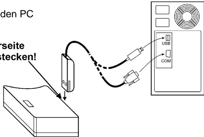
Nach Anschluss des Loggers an den PC ist mit der elproLOG-Software das Auslesen und das Einstellen / Programmieren des Loggers möglich.
