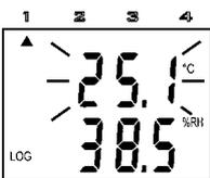
Aktive Alarme werden (bei eingeschaltetem Display) durch Blinken des jeweiligen Wertes und durch einen Pfeil beim entsprechenden Messeingang angezeigt.
