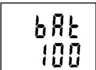
Anschliessend Anzeige der verbleibenden Batteriekapazität ( 0 – 100 % ) für ca. 2 Sekunden.
