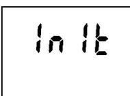
INIT erscheint z.B. nach dem Ersetzen einer komplett entladenen Batterie, (nach der Anzeige aller LCD-Segmente als Display Test). Diese Meldung erscheint für ca. 12 Sekunden.
