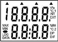
Nach dem Umprogrammieren des Loggers werden zur Überprüfung des Displays alle LCD-Segmente angezeigt.
