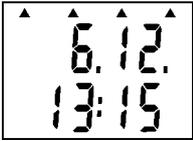
Warnung Datum / Zeit: Nach festgestelltem Spannungsabfall der Batterie, z.B. auch nach einem Batteriewechsel, erscheinen im Display alle 4 Pfeile. (keine Einschränkung der Loggerfunktionen !) Überprüfen Sie Datum und Zeit und setzen Sie diese gegebenenfalls via PC-Software neu.
