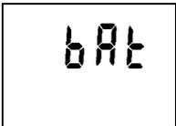
Wenn BAT permanent im Display sichtbar, ist Batteriespannung zu tief, der Logger kann nicht mehr eingeschaltet werden. War das Gerät vorher schon eingeschaltet, wird die Aufzeichnung gestoppt und der Logger ausgeschaltet. Kommunikation mit PC ist vorübergehend noch möglich, **Batterie ist sofort zu ersetzen!**
