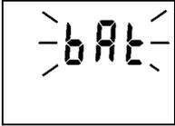
Wenn BAT durch periodisches Blinken angezeigt wird (für 1 Sekunde im 10 Sekunden-Intervall) ist das Ende der errechneten Batterielebensdauer erreicht. Batterie umgehend ersetzen!
